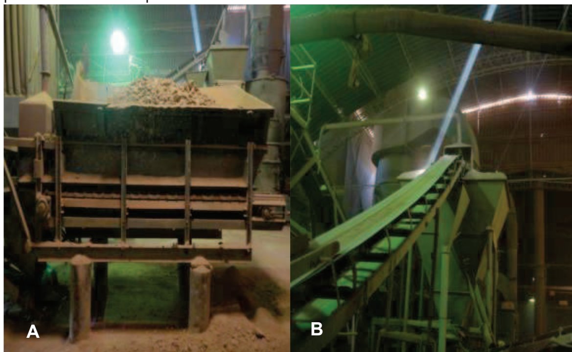
Figura 19 – A – Caixão esteira: etapa de moagem; B – Transporte da massa das peneiras ao moinho pendular
