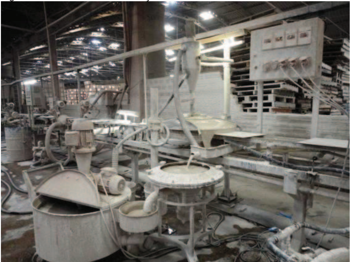
Figura 10 – Processo de esmaltação
