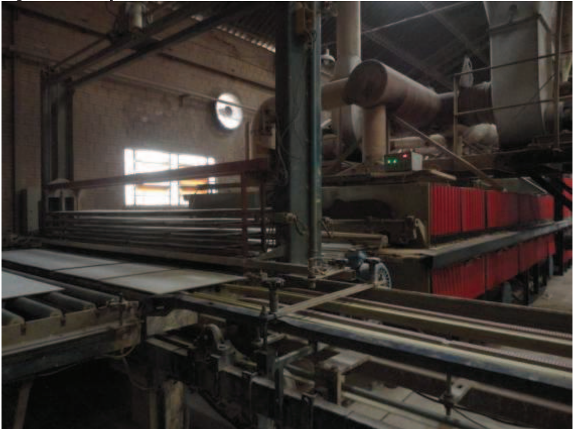
Figura 11 – Peças encaminhadas ao forno
