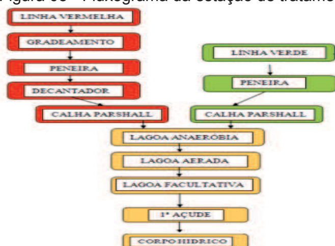
Figura 05 - Fluxograma da estação de tratamento com linhas verdes e vermelhas
