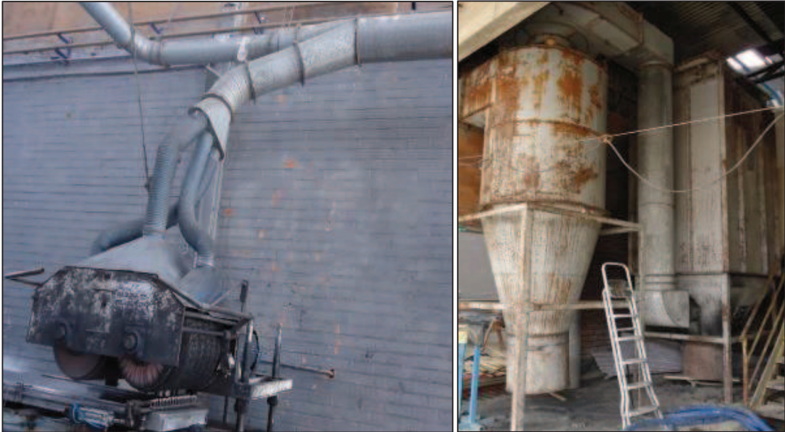
Figura 10 – A: Politriz automática; B: Sistema de tratamento de material particulado
