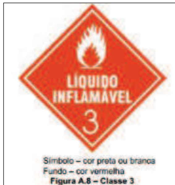
Figura 1 – Rótulo de risco para líquido inflamável
