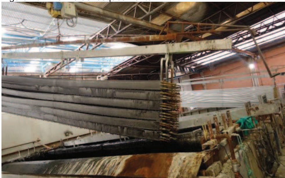
Figura 13 – Banho de fosqueamento
