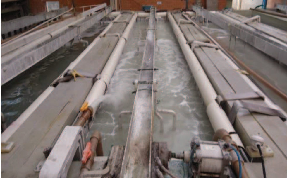
Figura 14 – Banho de anodização
