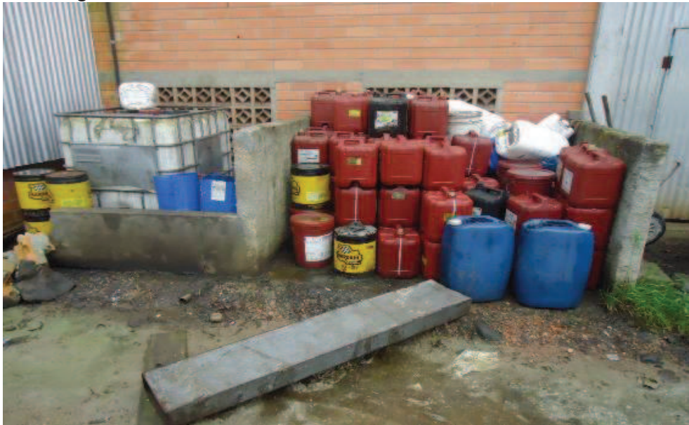
Figura 26 – Armazenamento inadequado de óleo usado e embalagens de óleo usadas
