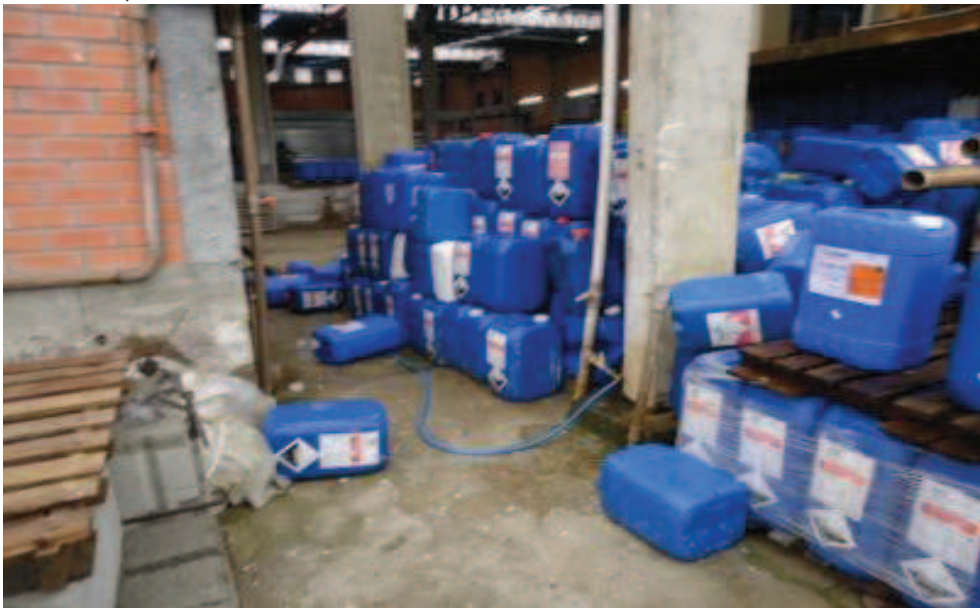
Figura 28 – Armazenamento inadequado de embalagens de ácido sulfúrico, hidróxido de amônio e aditivos usadas
