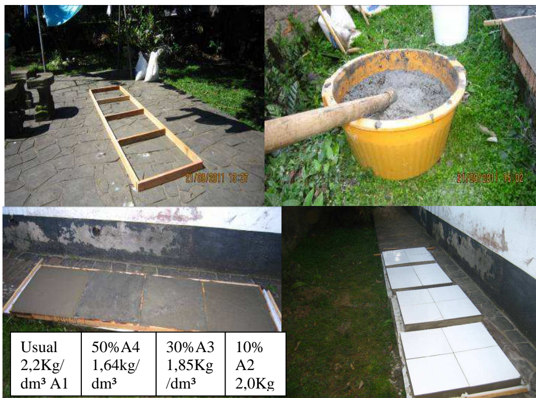
Figura 7 - Forma, argamassa, amostras e amostras com cerâmica.
