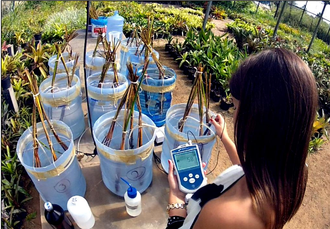
Figura 4 – Detalhe das bombonas plásticas (parcelas experimentais) preenchidas com solução nutritiva e mantidas sob aeração constante com aeradores de aquário e a medição diária do pH.
