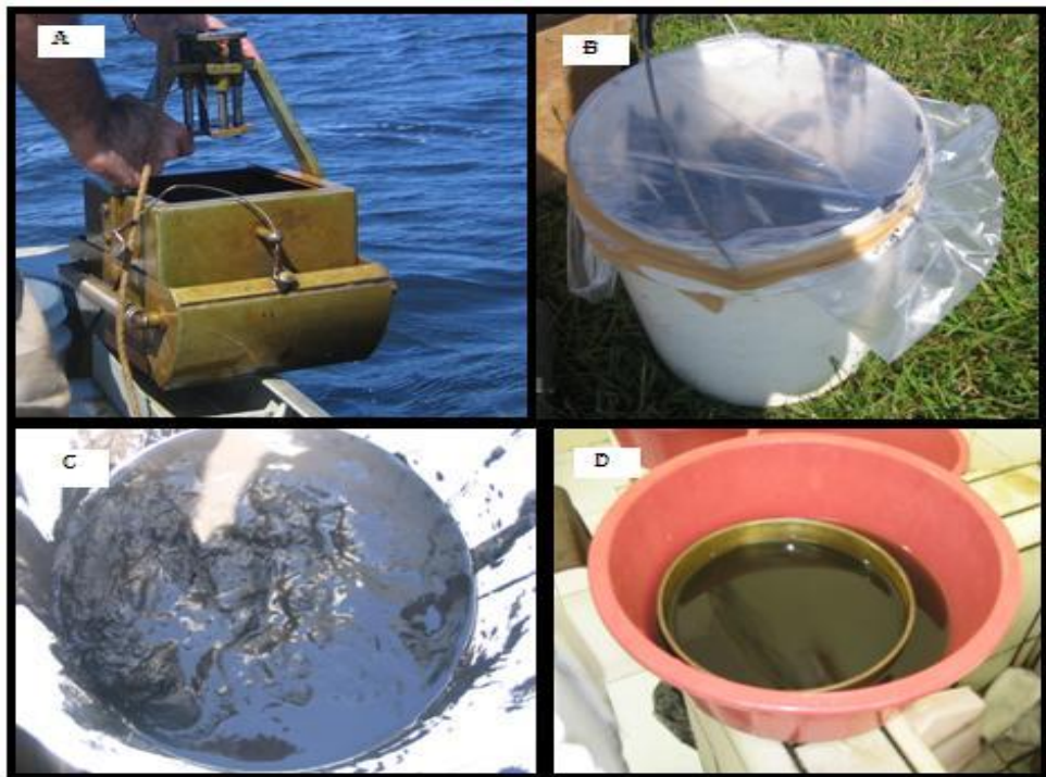
Figura 9 - Amostragem do sedimento, onde: A) detalhe da draga; B e C) armazenamento do sedimento até ser transportado ao Laboratório; e D) sedimento em laboratório para a análise.
