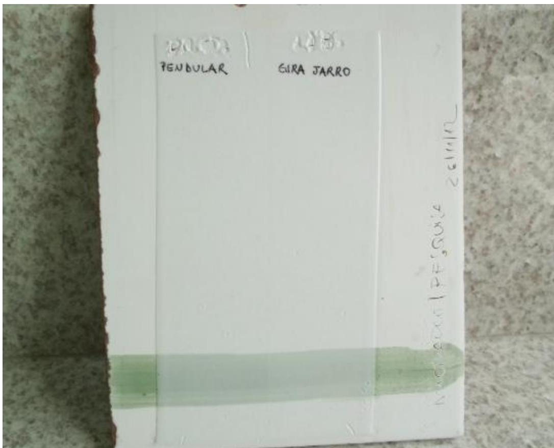
Figura 08 – Fotografia das amostras Pendular e Gira-jarro aplicadas sobre um substrato cerâmico. (Fonte: a autora, 2012).
