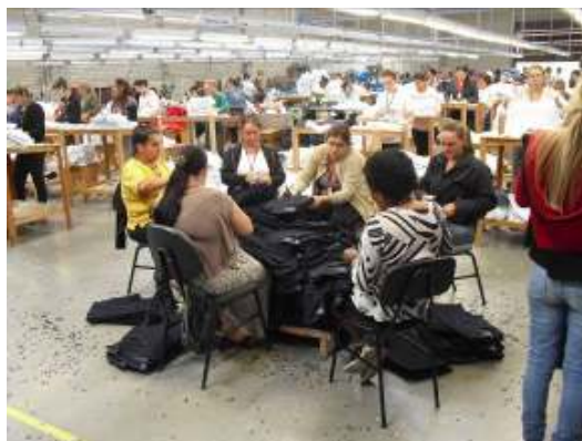
Figura 3: retirada de fios e excesso de tecidos , (CUNHA, 2013)
