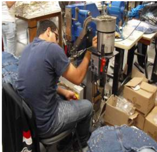
Figura 1: colocação de botões e/ou arrebitos, (CUNHA, 2013)
