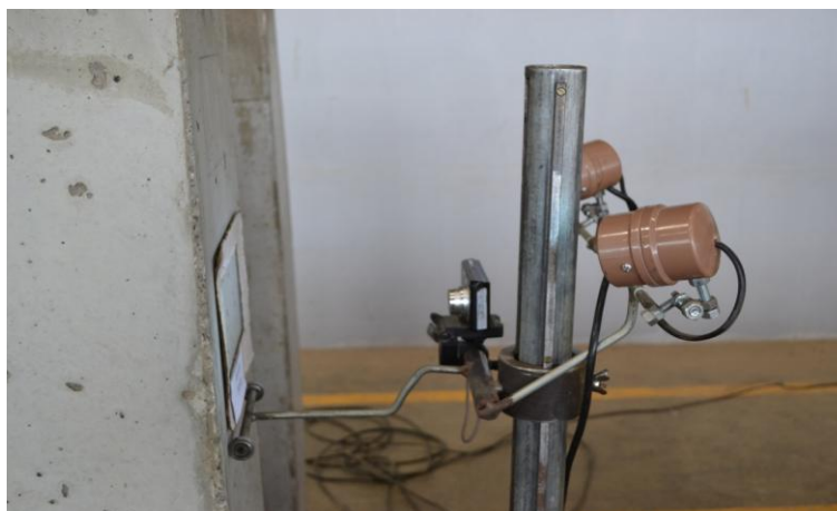
Figura 02 Vista lateral que mostra a barra de limitação do aparato em relação a peça. Fonte: Rodrigo Walnier (2011)
