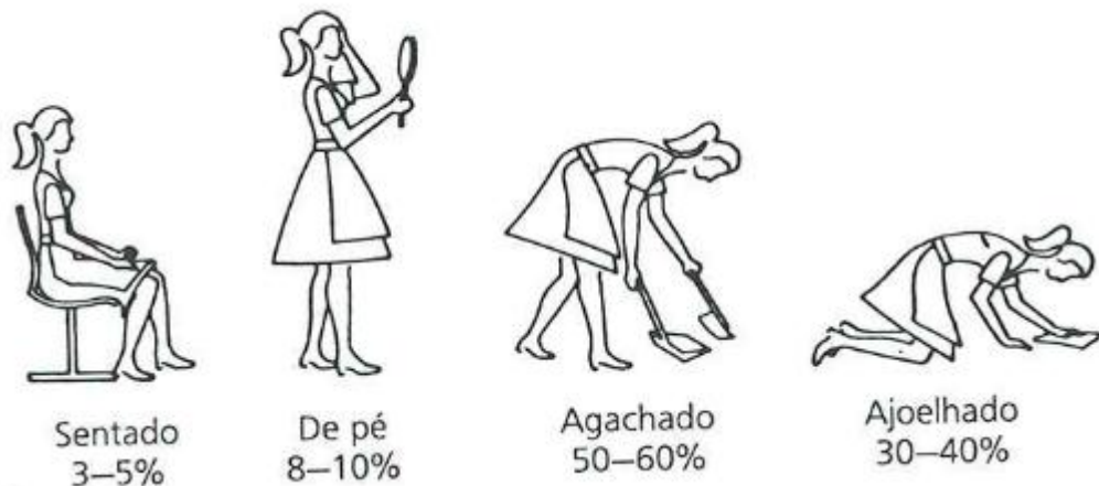
Figura 5 - Incremento percentual de consumo energético para diferentes posturas. 100% = consumo de energia na postura deitada. O incremento relativo, como uma porcentagem, é o mesmo para o homem e para a mulher
