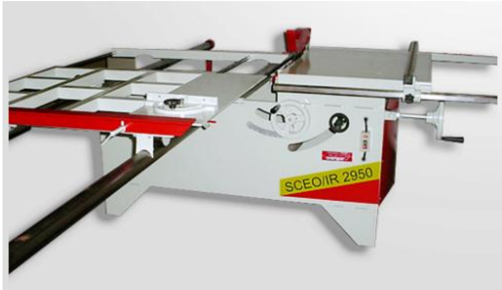
Figura 13 - Serra circular esquadrejadeira com eixo inclinável – linha leve
