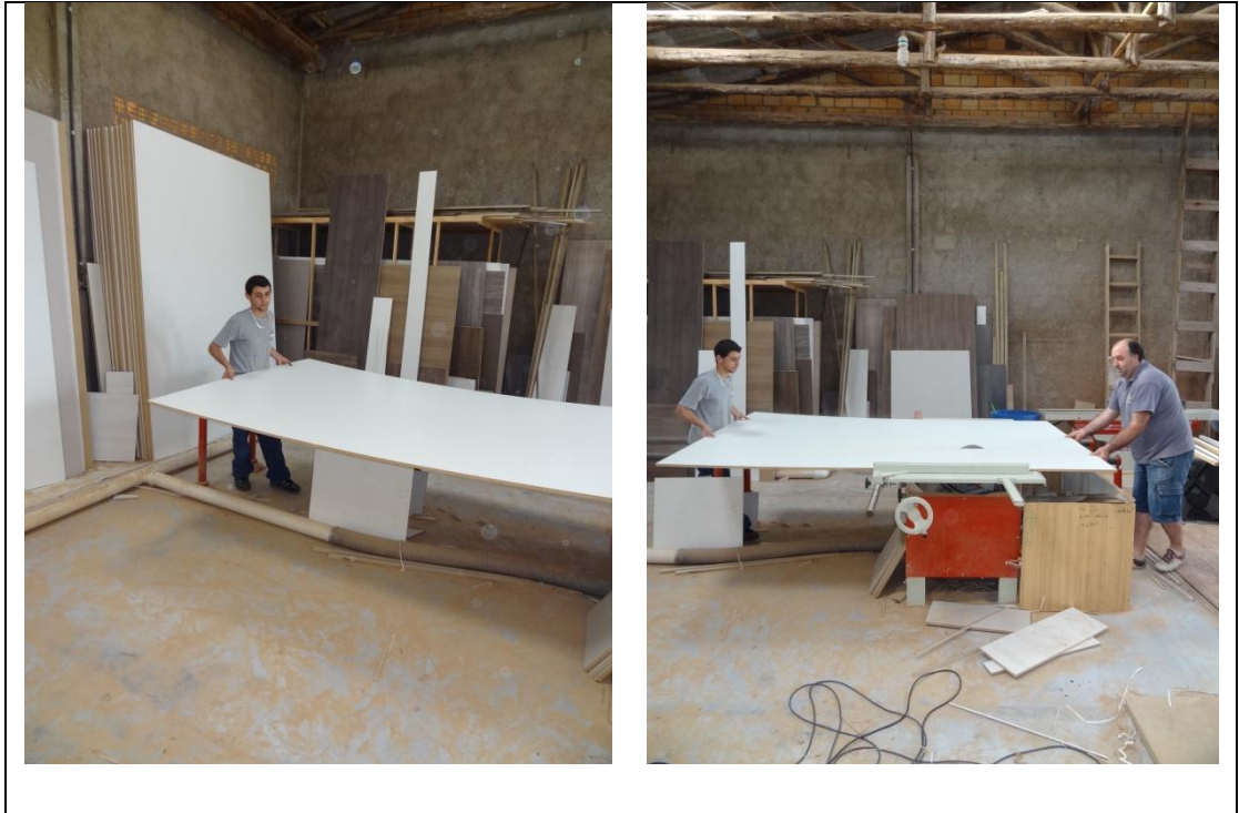
Figura 16 - Chapa de MDF sendo depositada sobre a serra circular e sendo cortada.
