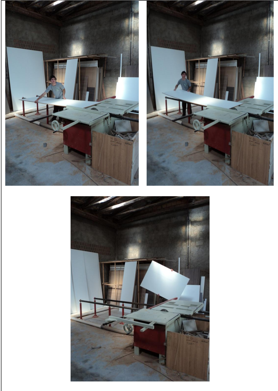
Figura 17 - Chapa de MDF sendo cortada por apenas um funcionário.
