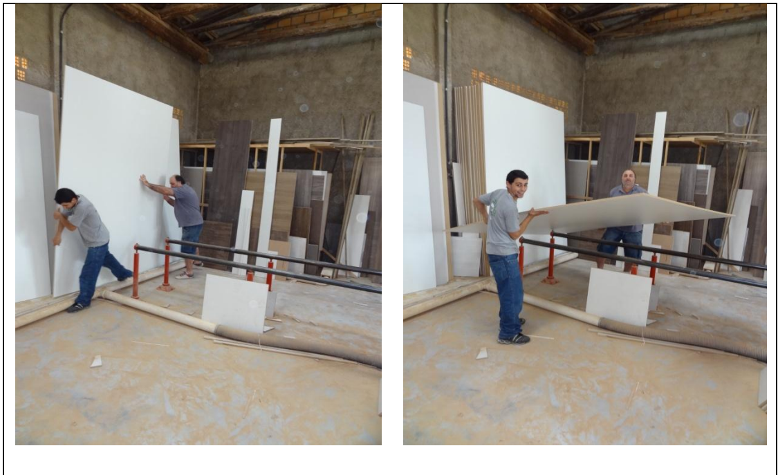
Figura 15 - Seleção da chapa de MDF e colocação da mesma para corte
