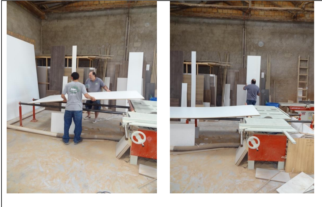
Figura 18 - A chapa sendo recolhido para um novo corte e a parte que não será utilizada sendo depositada ao fundo da imagem
