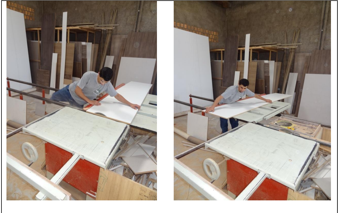
Figura 19 - Chapa cortada sendo colocada no esquadro
