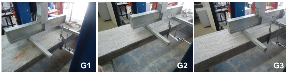
Figura 8 – Ensaio de flexão nos grupos G1, G2 e G3
