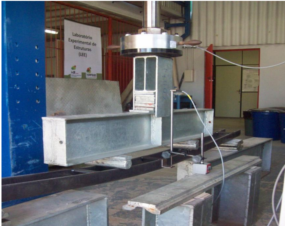
Figura 13: Ensaio à flexão estática (Perfil 02)
