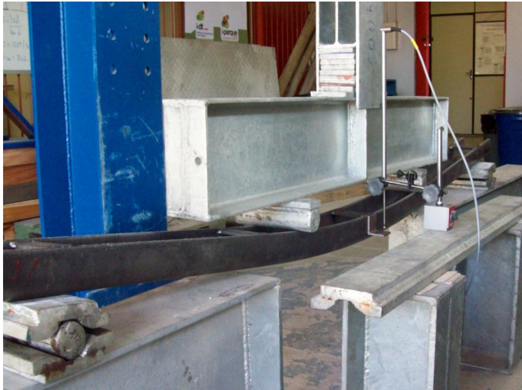
Figura 11: Ensaio à flexão estática (Perfil 01)
