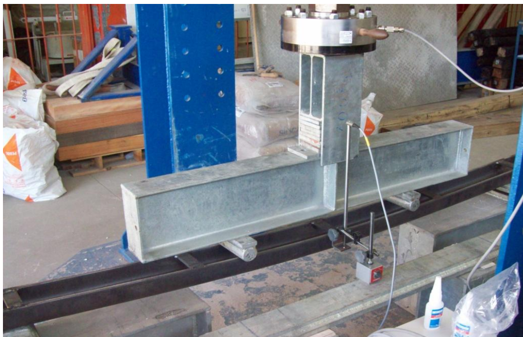
Figura 15: Ensaio à flexão estática (Perfil 03)
