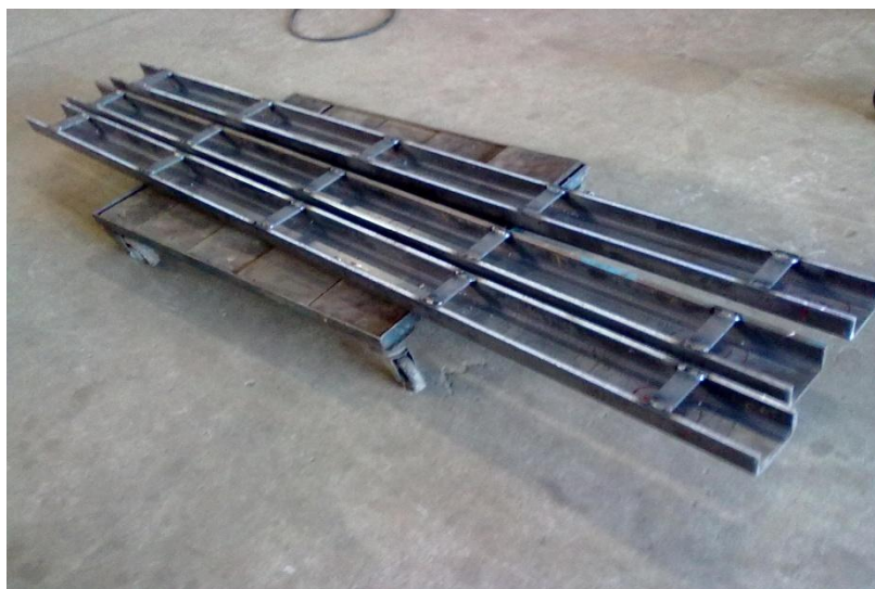
Figura 5: Talas de aço soldadas nas abas do perfil
