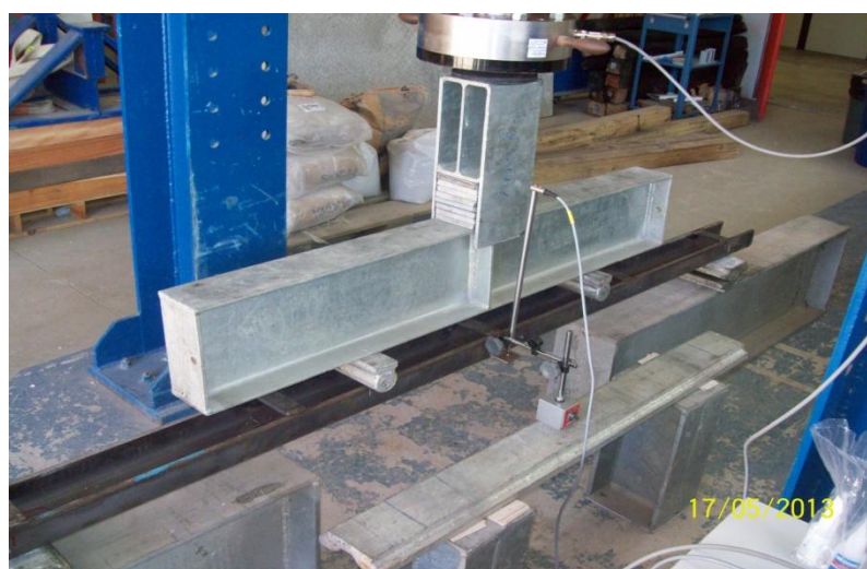
Figura 06: Posicionamento do perfil para realização o ensaio
