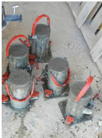
Figura 2: Separação dos corpos de prova para ensaio de compressão simples
