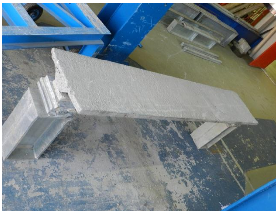
Figura 4: Laje finalizada pronta para o ensaio (seção “T”)
