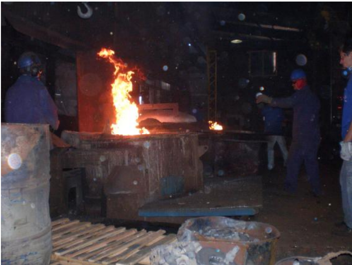
Figura 4 - Fornos de indução da empresa Metalúrgica DS Ltda.
