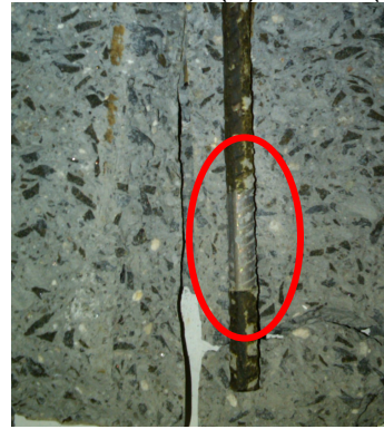
Figuras 5a e 5b: Inspeção do aço nas amostras CA1(a) e CS2(b) - Secas
