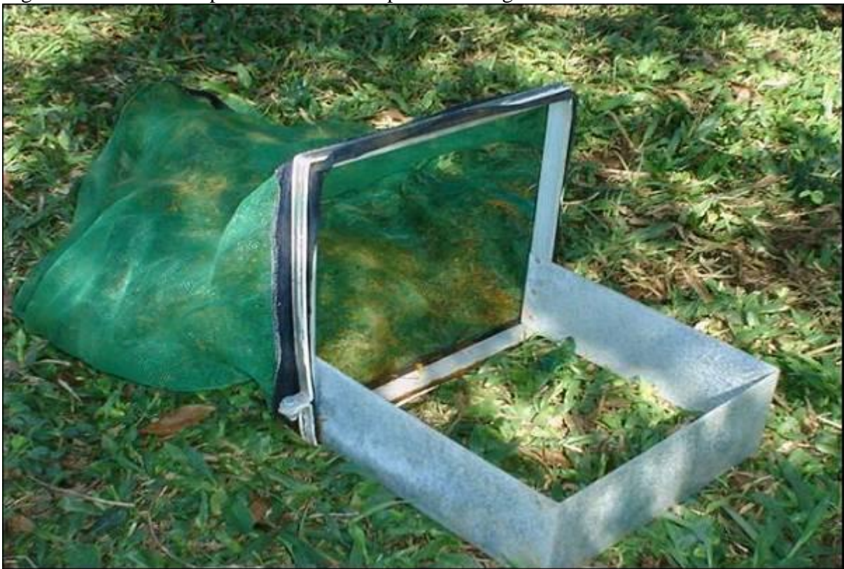
Figura 7 - Coletor do tipo Surber utilizado para amostragem de macroinvertebrados.
