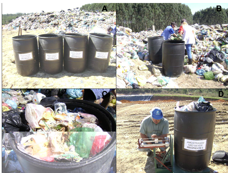
Figura 2 - Método de quarteamento. A: Recipientes utilizados para o acondicionamento dos resíduos depois do quarteamento; B: Colocação dos resíduos nos recipientes; C: Recipiente cheio de resíduos dos mais variados tipos; D: Pesagem do recipiente cheio. Aterro Sanitário, CIRSURES, Rio América, Urussanga, SC. Fonte: (SOUZA, G. C. de, 2008).
