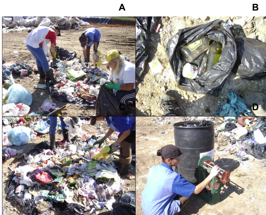
Figura 3 - Método de quarteamento. A: Separação dos resíduos conforme as categorias; B: Acondicionamento do componente vidro; C: Triagem dos resíduos; D: Etapa de pesagem. Aterro Sanitário, CIRSURES, Rio América, Urussanga, SC.
