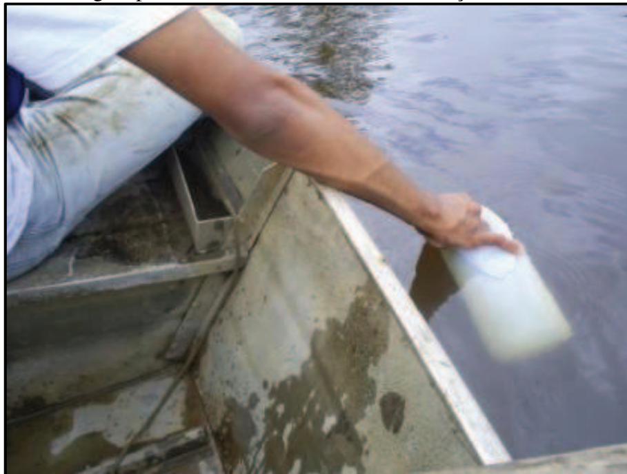
Figura 6 - Coleta de água, para análise de metais referente ao açude 1.
