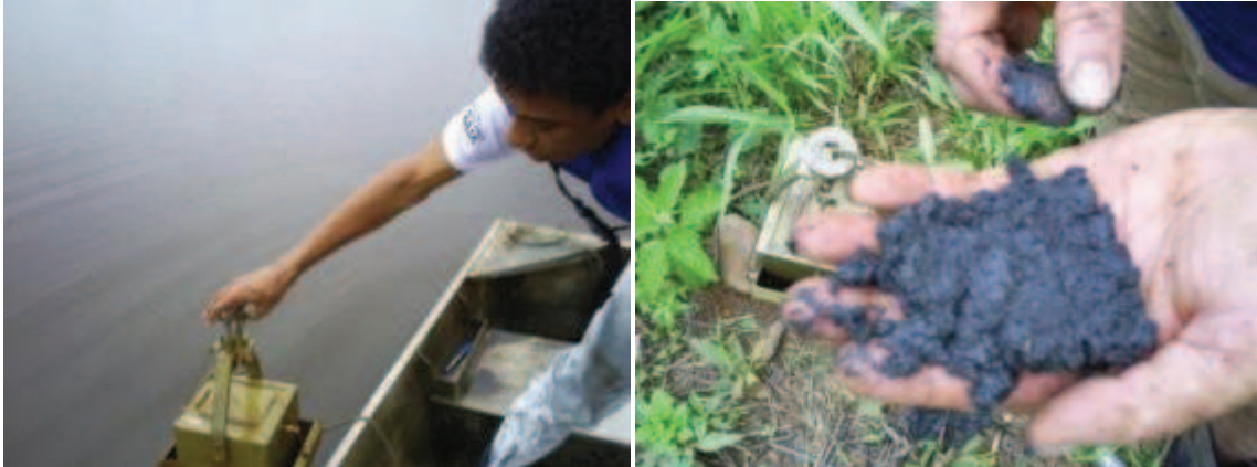
Figura 8 - Coleta de sedimento de fundo, com uso de draga modelo Eckman.
