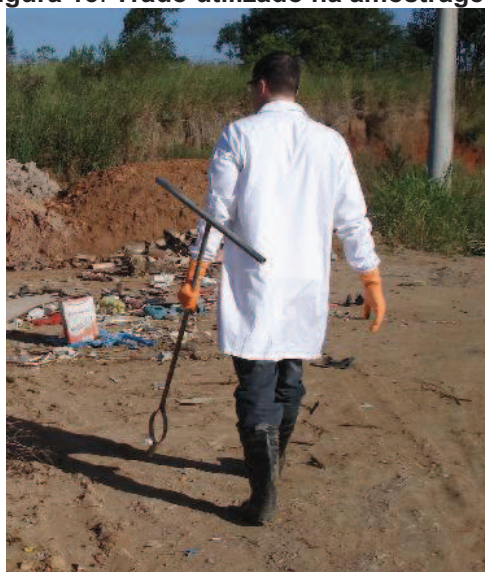
Figura 13: Trado utilizado na amostragem.
