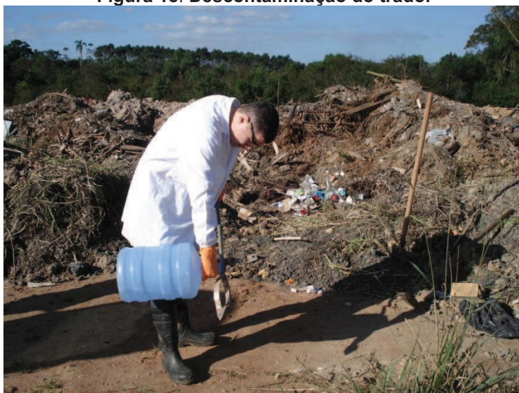
Figura 18: Descontaminação do trado.
