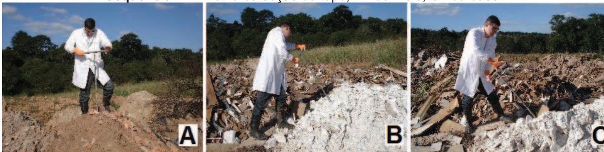
Figura 16: Coleta das amostras nas pilhas. Seqüência: A – Retira da seção do topo, B - do meio, C - da base.
