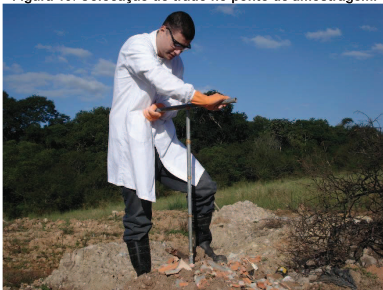
Figura 19: Colocação do trado no ponto de amostragem.
