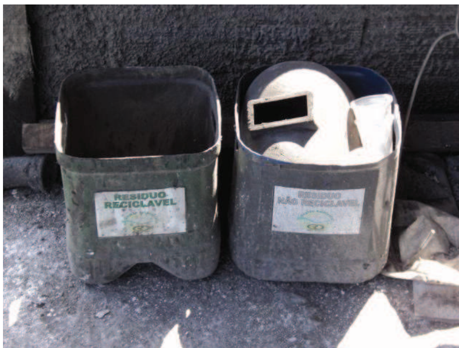
Figura 20: Lixeiras dispostas num setor da unidade, que apresentavam capacidade incompatível com o tamanho dos resíduos gerados.
