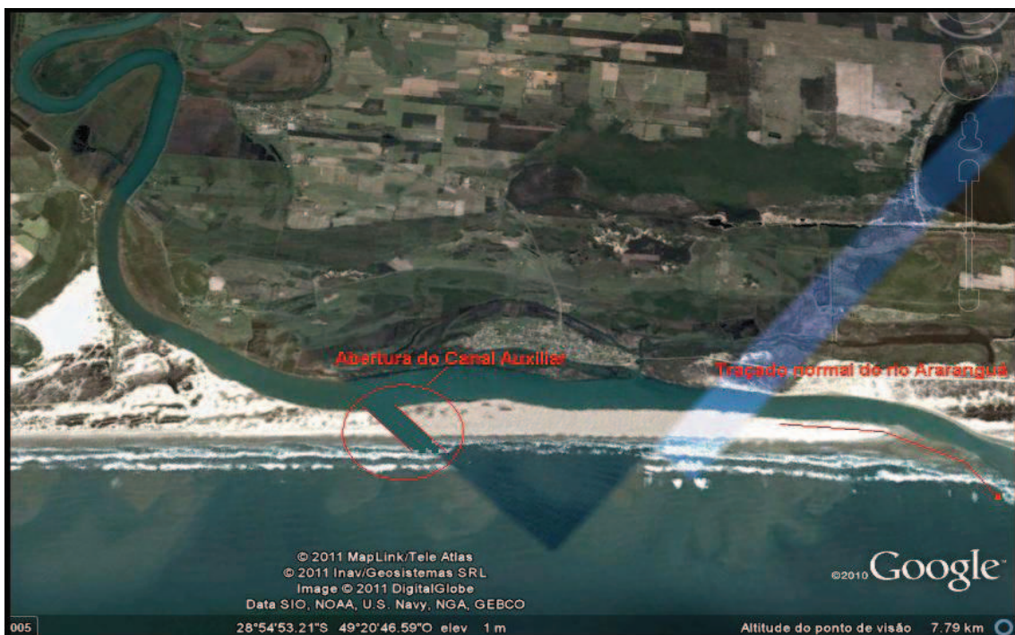
Figura 27: Localização de onde foi aberto o canal auxiliar, e de onde é o escoamento natural das águas do rio Araranguá, fato que facilitou o escoamento das águas do Rio Araranguá em direção ao Oceano Atlântico. Fonte: Coordenadoria Municipal de Defesa Civil de Araranguá.
