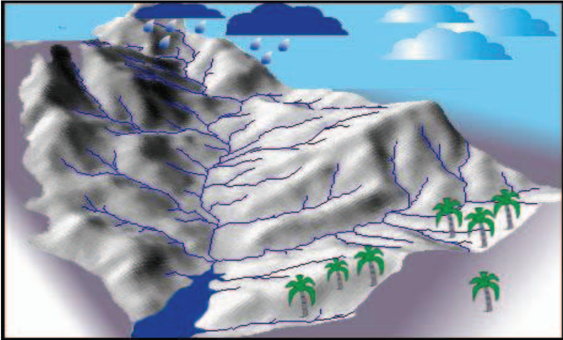
Figura 5: Divisor de águas de uma bacia. Fonte: Agência Nacional de Águas.
