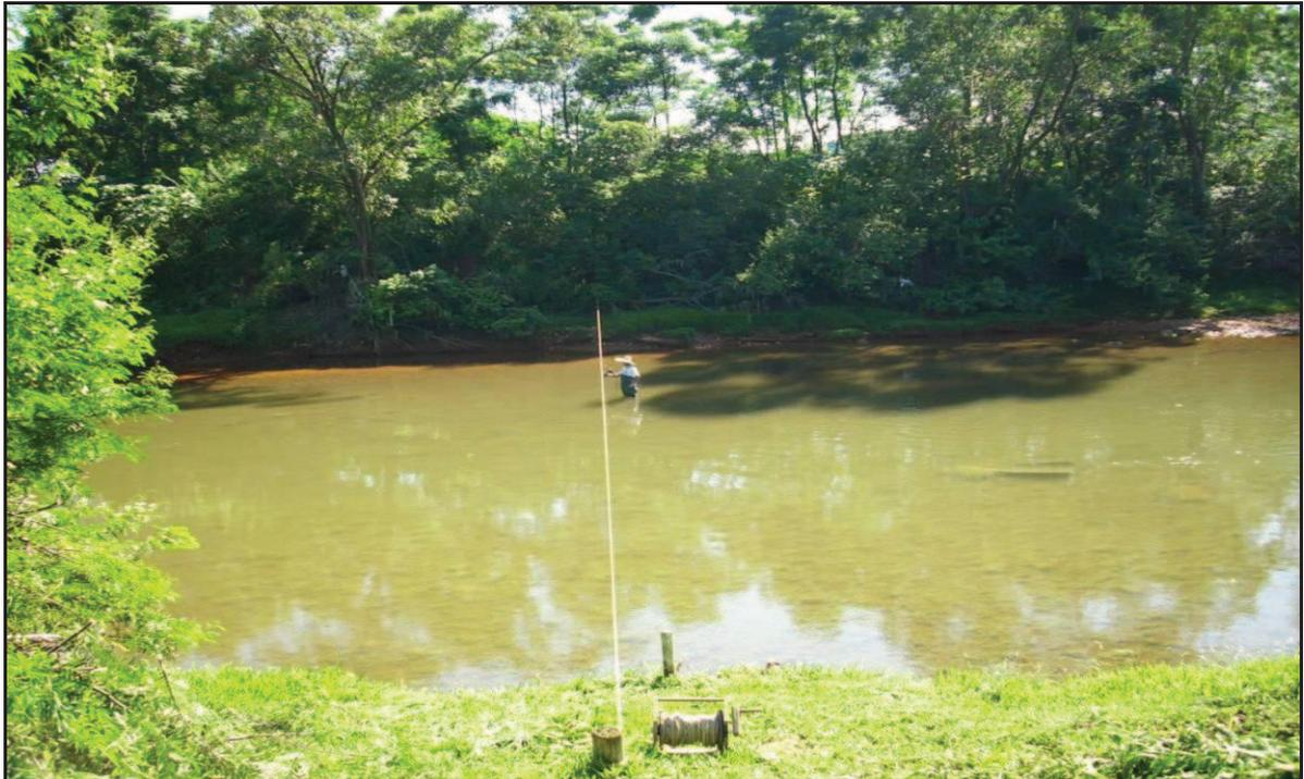
A determinação da área da seção é realizada a partir da medição da abscissa, da profundidade do rio em um número significativo de pontos ao longo da seção. Estes pontos definidos ao longo da seção determinam as verticais que ligam a superfície livre ao fundo do rio; e nessas mesmas verticais, são realizadas as medições de velocidade com o molinete hidrométrico em certo número de pontos – variando em função da profundidade. (MELCHIOR, 2009, p.37).
