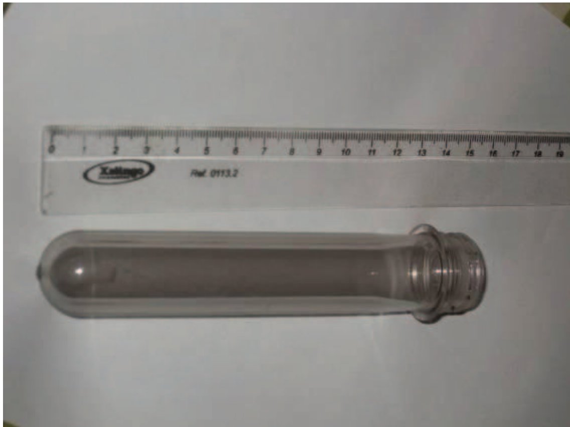
Figura 16 - Pré-forma da garrafa PET de dois litros.
