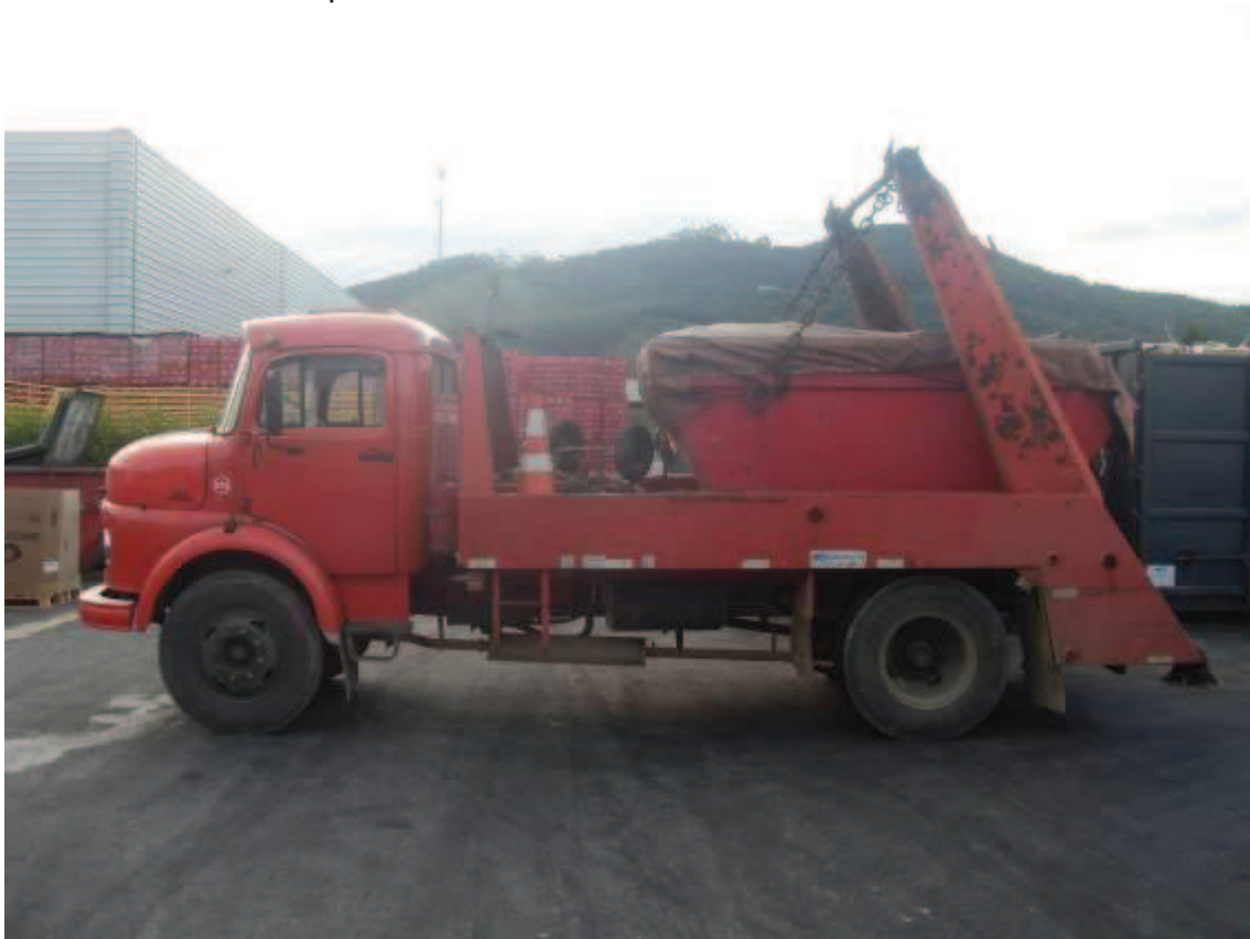
Figura 20 – Caminhão poli guindaste utilizado atualmente para levar o lodo e resíduo de descarte para o aterro industrial.
