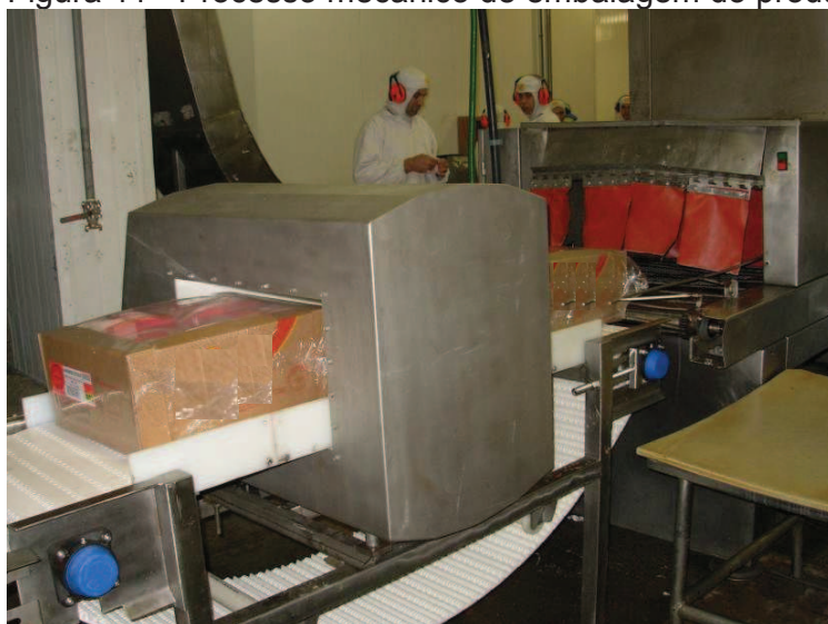
Figura 11 - Processo mecânico de embalagem do produto.
