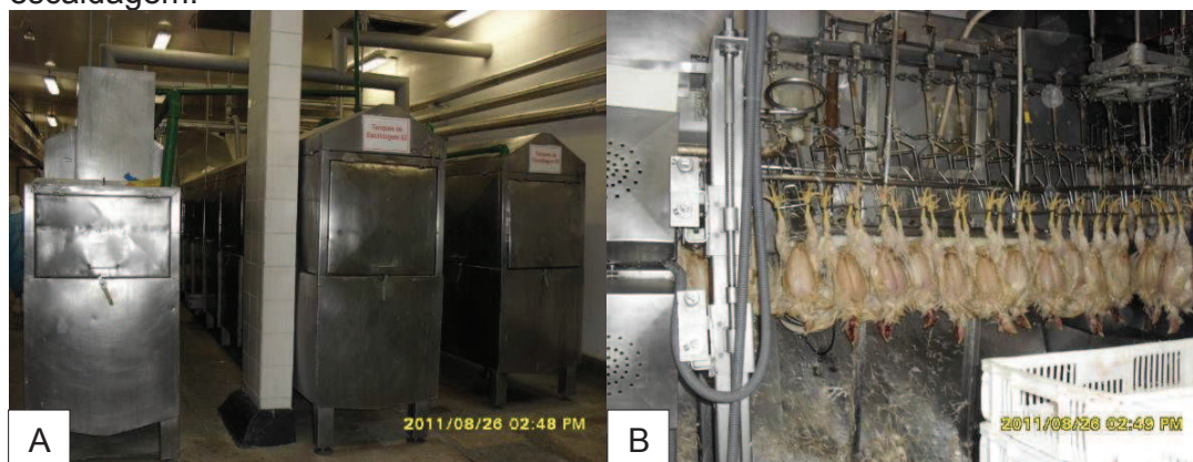
Figura 6 – A) Tanques de escaldagem 1 e 2; B) Saída do frango do processo de escaldagem.
