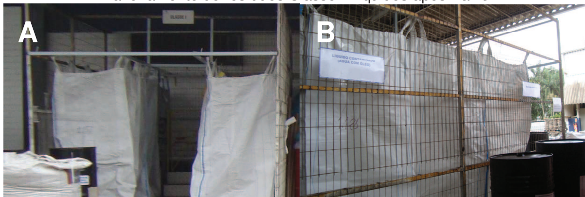
Figura 29 - A) Armazenamento de resíduos Classe I Sólidos após Kaizen ; B) Armazenamento de resíduos Classe I Líquidos após Kaizen .
