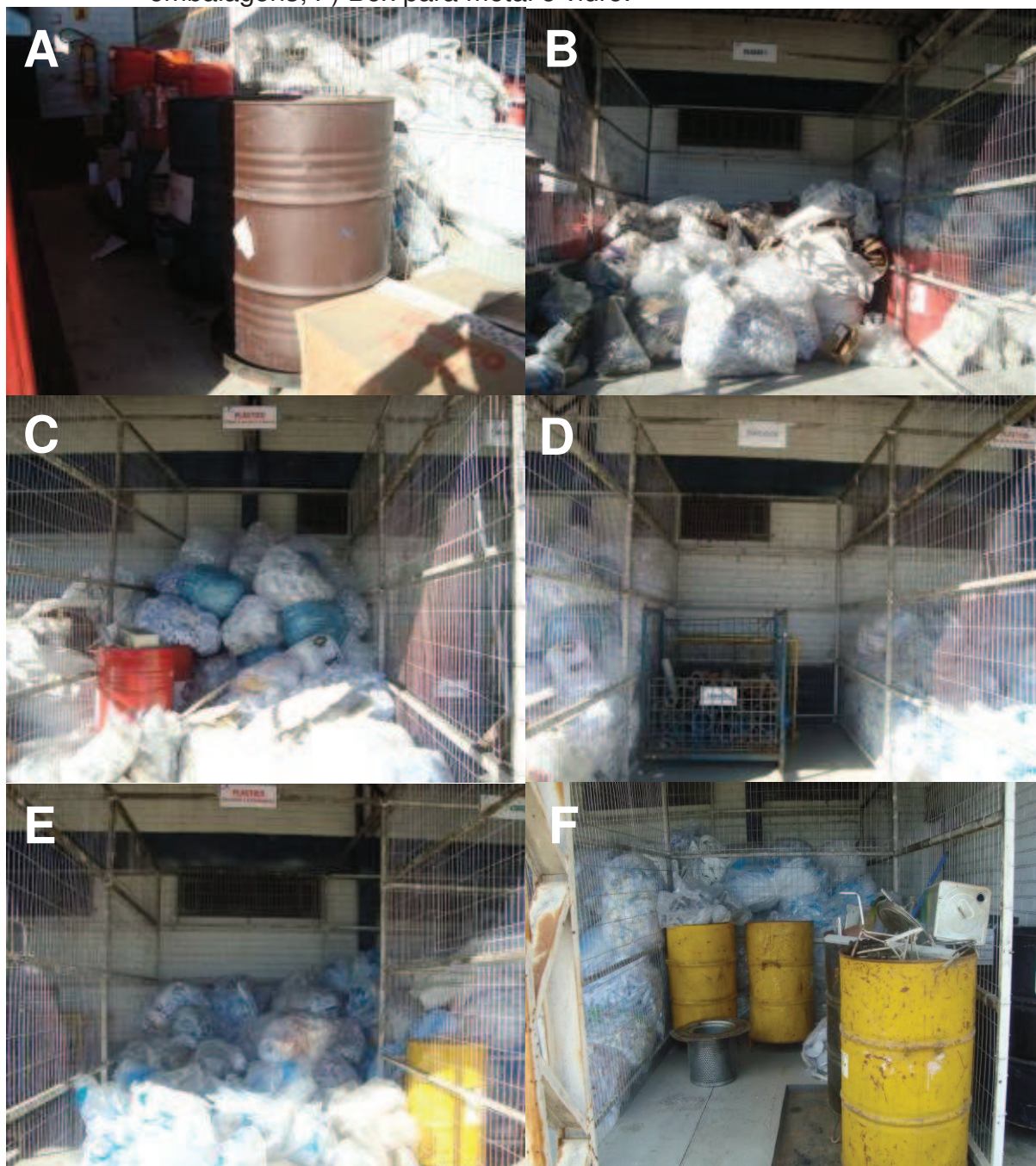
Figura 19 - A) Box para líquidos Classe I; B) Box para sólidos Classe I; C) Box para plástico em geral e borras; D) Box para tarugos; E) Box para sacarias e embalagens; F) Box para metal e vidro.
