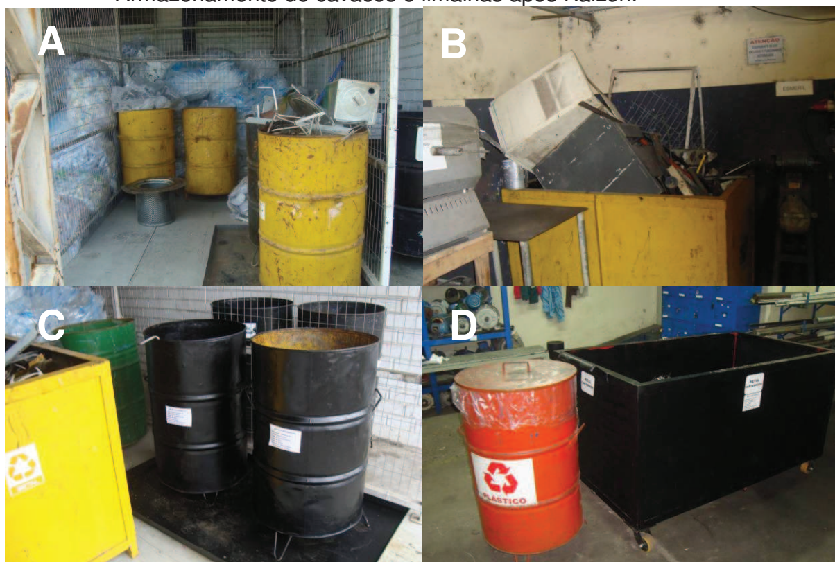
Figura 28 - A) Armazenamento de metais no Box de resíduos antes do Kaizen ; B) Armazenamento de metais no setor de manutenção antes do Kaizen ; C) Box de resíduos para metais e metais contaminados após Kaizen ; D) Armazenamento de cavacos e limalhas após Kaizen .
