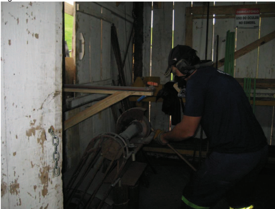
Figura 31 - Mecânico de martelo afiando broca no esmeril.
