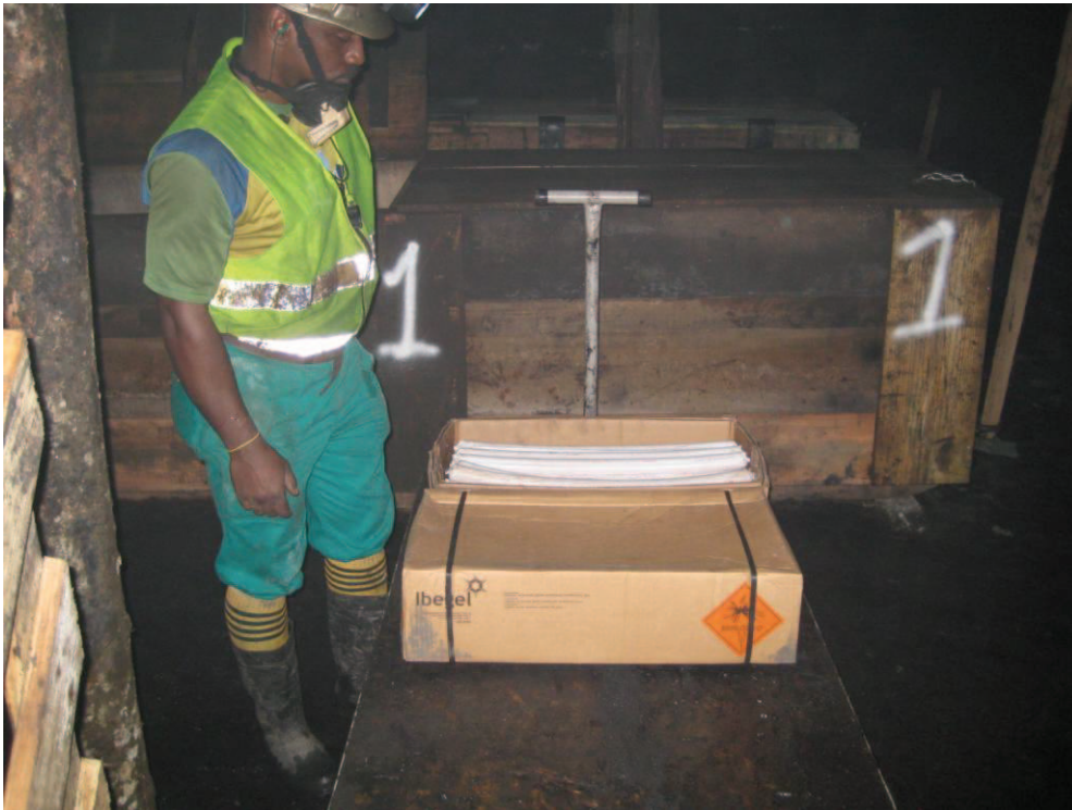
Figura 18 - Blaster preparando os explosivos para serem levados até a frente de lavra.
