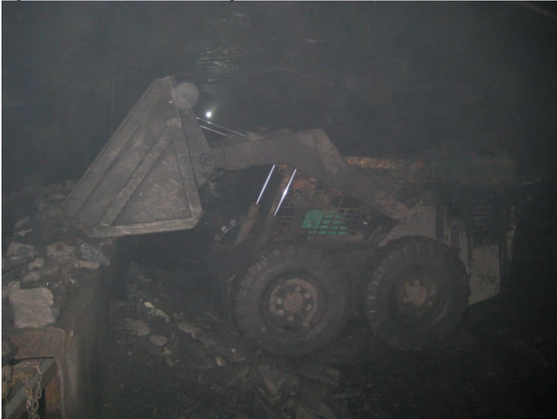
Figura 21 - Micro trator descarregando carvão na cauda
