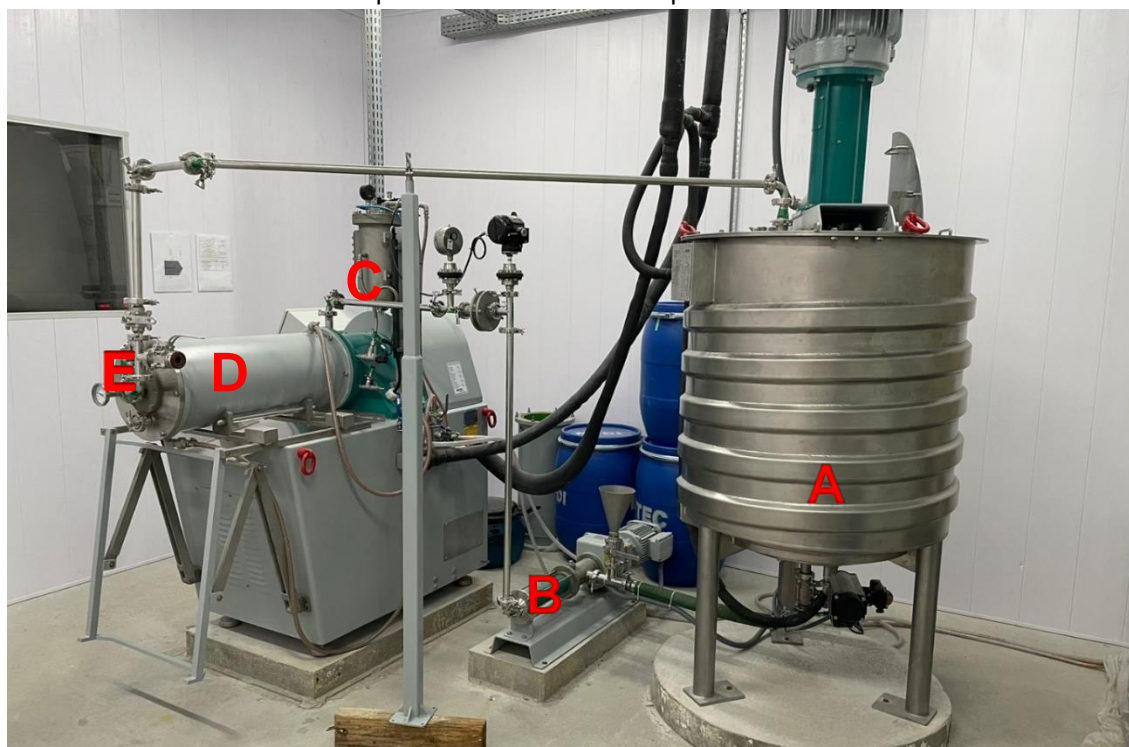
Figura 8. Equipamento MAE marca Netzsch modelo Discus 30 com (A) Agitador Mastermix 15 ; (B) bomba de alimentação NEMO ; (C) selo mecânico/entrada de produto; (D) câmara de moagem e (E) peneira tubular/saída de produto.
