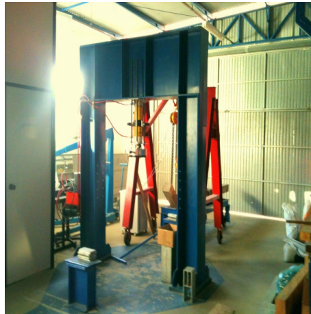
Figura 7 - Pórtico de reação
