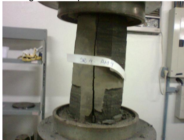
Figura 4 - Ruptura do testemunho.
