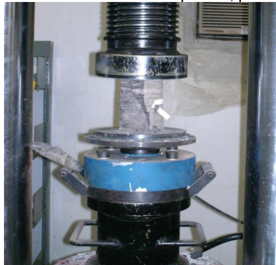
Figura 3 - Testemunho colocado na prensa, para medir sua RCS.
