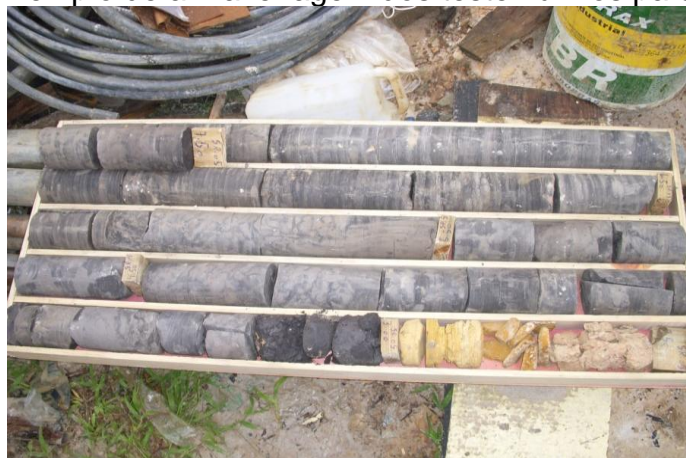
Figura 2 - Exemplo de armazenagem dos testemunhos para transporte.
