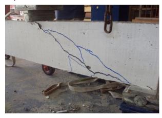
Figura 10 – Detalhe da ruptura Estribos contínuos V01
