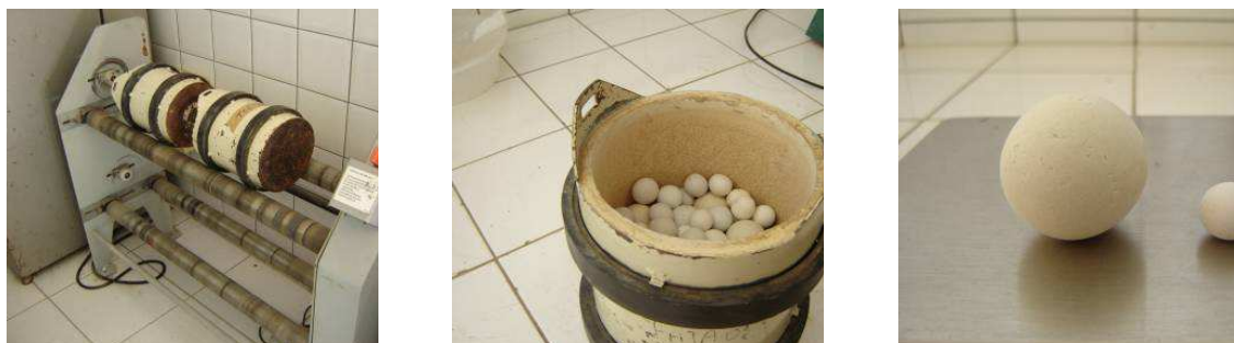
Figura 13. (a) moinho de bolas; (b) carregamento do moinho; (c) tamanho das bolas, do autor, 2009.
