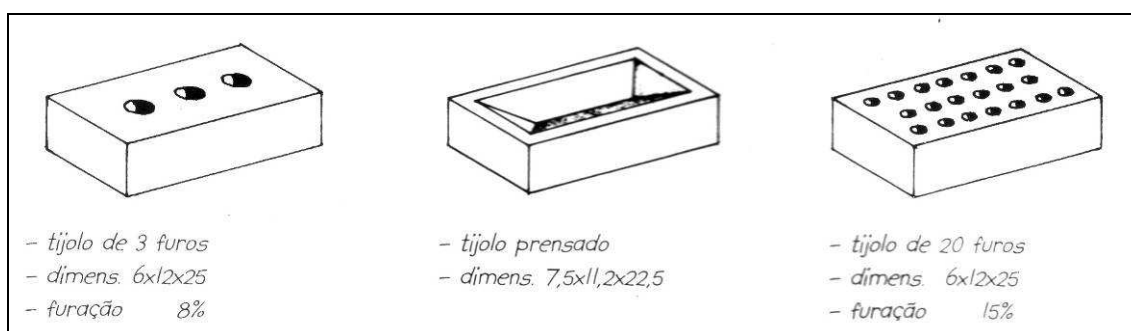
Figura 5. Tipos de tijolos maciços, FACINCANI, 1992
