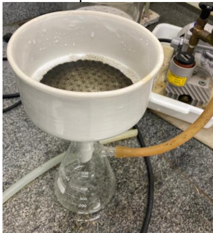
Figura 7: Filtração a vácuo de efluente tratado por eletrólise.
