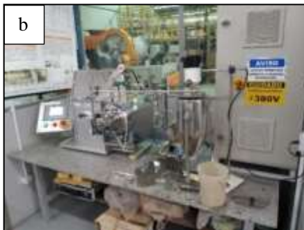
Figura 21 - Moinhos e lâ de vidro moída (a) moinho de bolas modelo MB 6595 C, (b) moinho de bolas de alta energia modelo LMZ 0,5, (c) moinho de bolas marca Servitech, modelo CT - 242, (d) lâ de vidro após moagem inicial e (e) lâ de vidro moída e na forma de pasta após moagem em alta energia a úmido.
