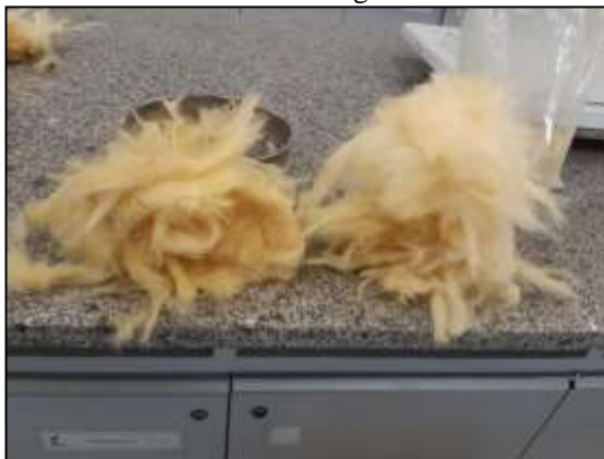
Figura 19 - Manta da lã de vidro desintegrada.
