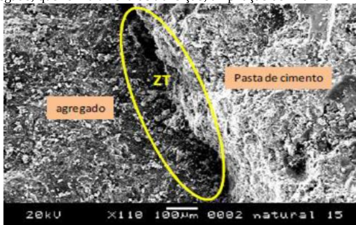
Figura 7- Micrografia do concreto na região da interface entre pasta e agregado, que forma a zona de transição; ampliação de 110\times em MEV.
