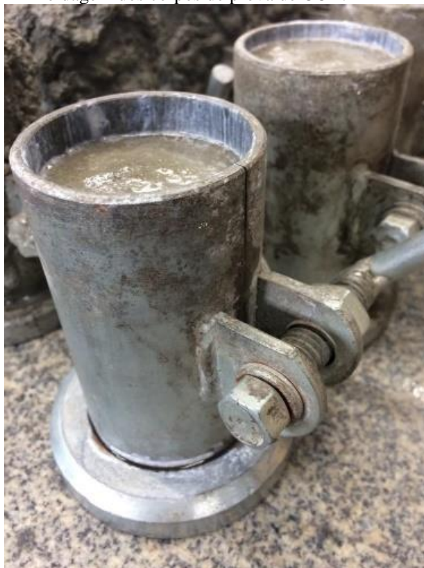
Figura 11 – Moldagem dos corpos de prova de CCA.
