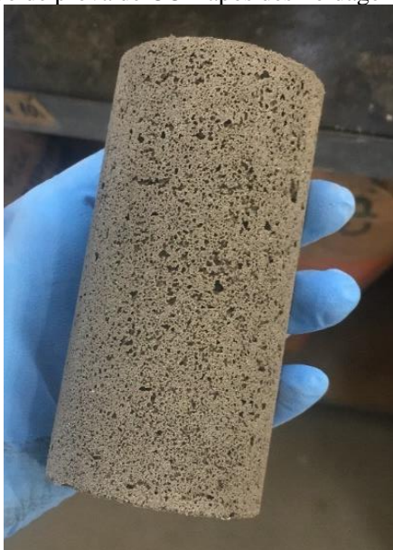
Figura 14 – Corpo de prova de CCA após desmoldagem
