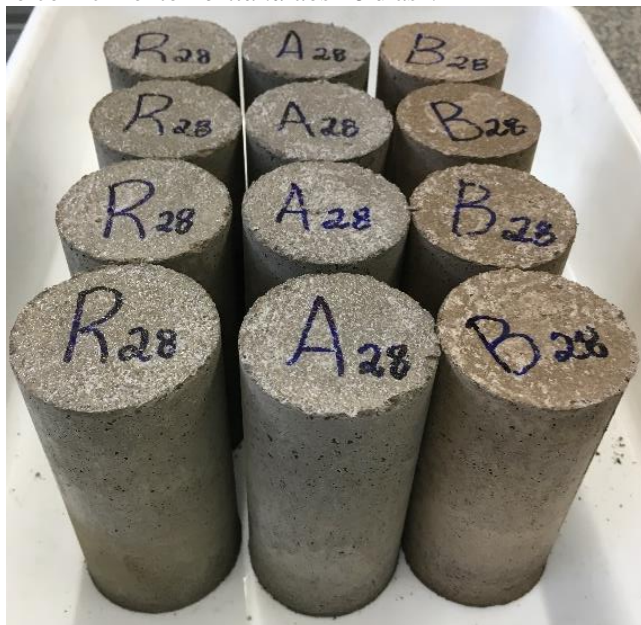
Figura 10 – Corpos de prova após cura para ensaio de “Índice de Desempenho com cimento Portland aos 28 dias”.
