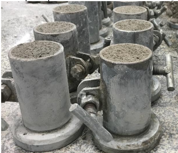
Figura 13 – Corpos de prova de CCA retificados com fio de nylon
