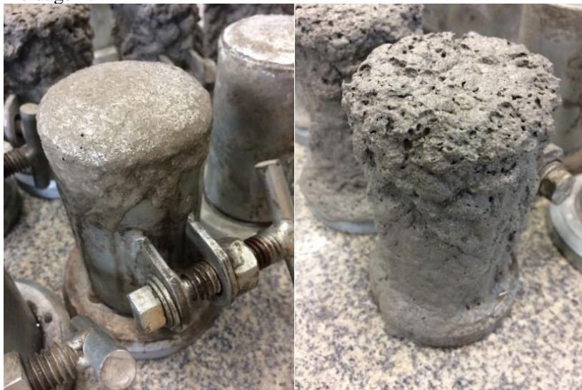
Figura 12 – Processo de expansão do CCA durante 1 hora após a moldagem.
