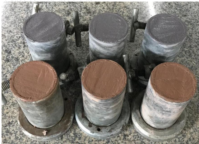
Figura 9 – Corpos de prova confeccionados para determinar o índice de pozolanicidade com cal aos 7 dias
