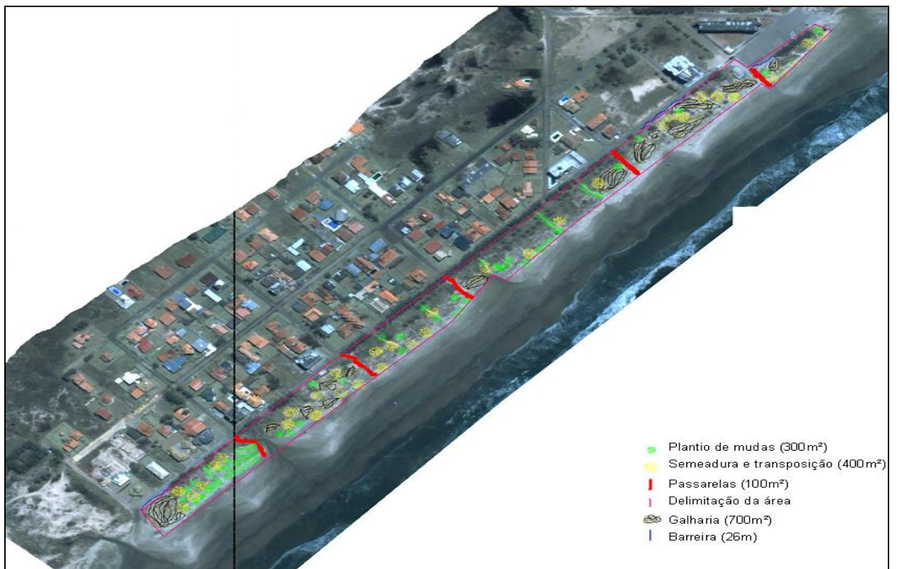
Figura 16 – Croqui das técnicas programadas para execução da proposta de recuperação.
