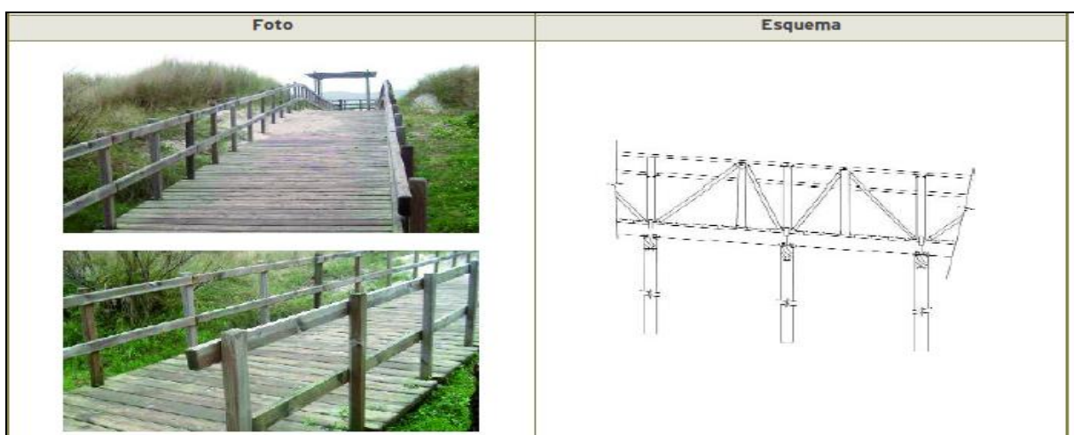
Figura 2 – Esquema das passarelas propostas por Seoane et al. (2007).
